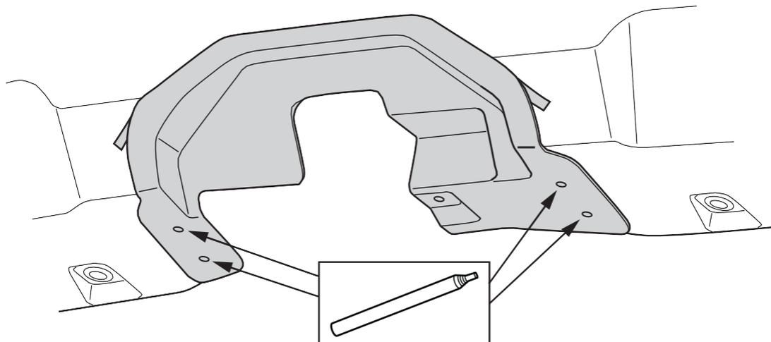
c) Retirer le panneau et percer quatre (4) trous à l'aide d'un foret de 8 mm.
