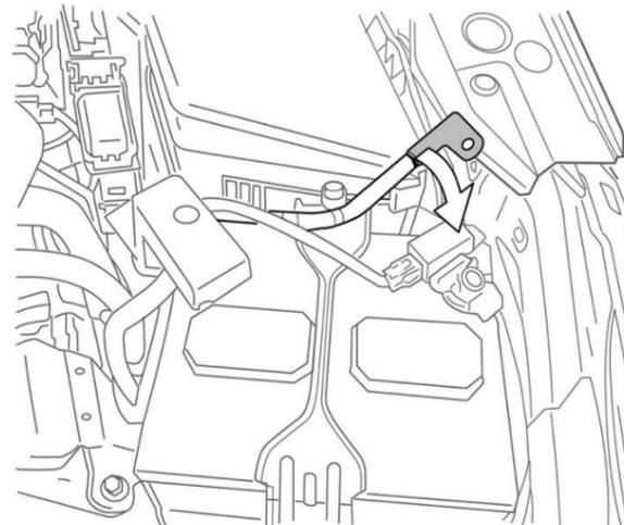
Brancher le câble de batterie négatif (-) à la borne du capteur de la batterie.
