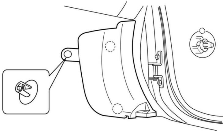
Retirer l'attache du côté conducteur et retirer le couvercle du seuil de porte lat
