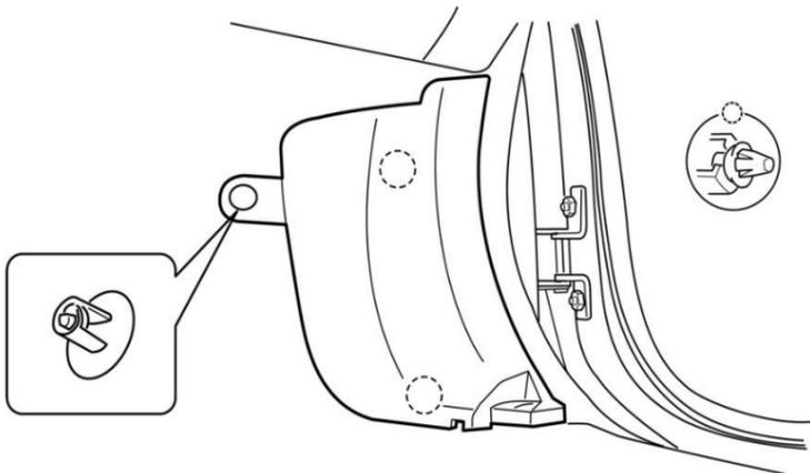
Retirer l'attache du côté conducteur et retirer le couvercle du seuil de porte latérale avant.
