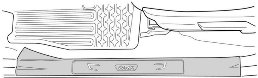
Installer le panneau de seuil de porte latérale illuminé, s'assurer que toutes les attaches sont correctement positionnées et que le seuil est solidement fixé
