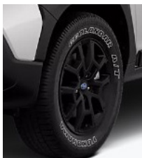
Alliage 18 po Dimension jante : 18 po x 7,0J Dimension des pneus : 225/55 R18
