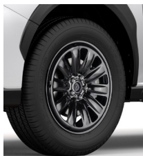
Acier 17 po Dimension jante : 17 po x 7,0J Dimension des pneus : 225/60 R17
