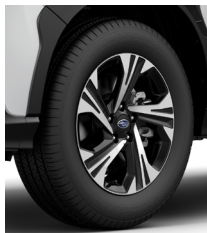
Alliage 17 po Dimension jante : 17 po x 7,0J Dimension des pneus : 225/60 R17
